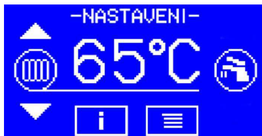
NASTAVOVÁNÍ ŽÁDANÉ HODNOTY TEPLoty TOPNÉ VODY
