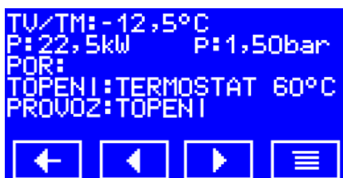
NÁVRAT – PŘEDCHOZÍ – NÁSLEDUJÍCÍ – MENU TLAČÍTKA NA 1. INFO OBRAZOVCE
