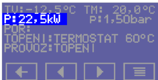
P: OKAMŽITÝ VÝKON KOTLE
